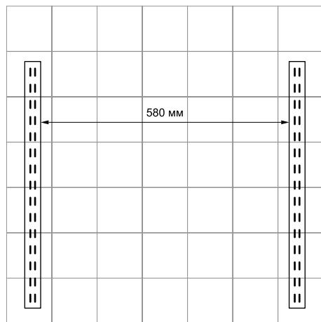
Если есть выдвижные элементы в системе «Классик», (выдвижные корзины в металлических рамках 550 мм, выдвижные брючницы, выдвижная полка 2-ярусная), расстояние между внутренними размерами направляющих 535 мм.
